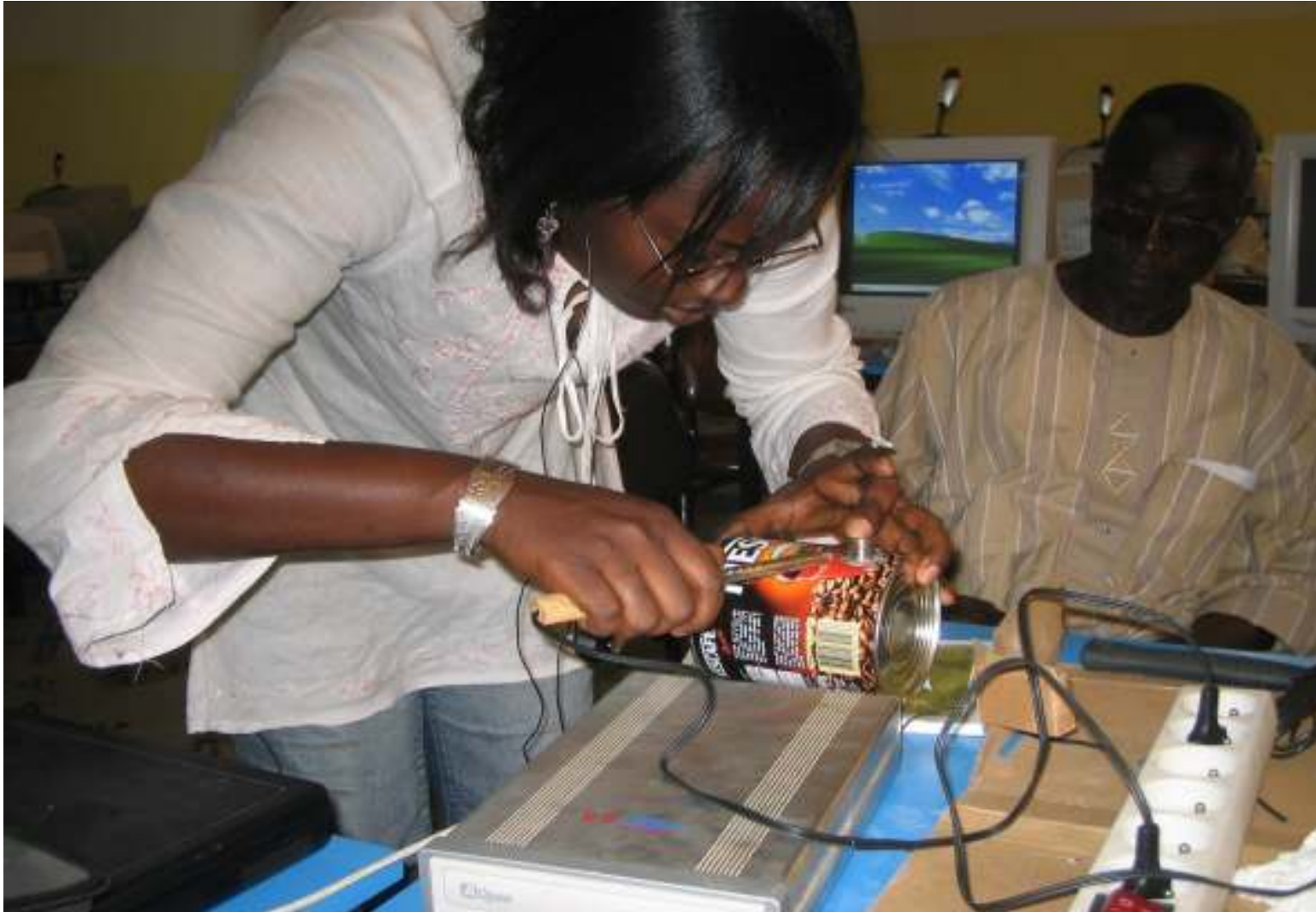
Une jeune stagiaire sénégalaise , fabriquant une antenne Wifi avec du matériel local
